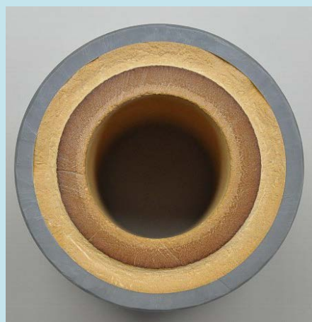
図1 送水パイプ(内径8cm)の内側に形成された石灰質温泉沈殿物
