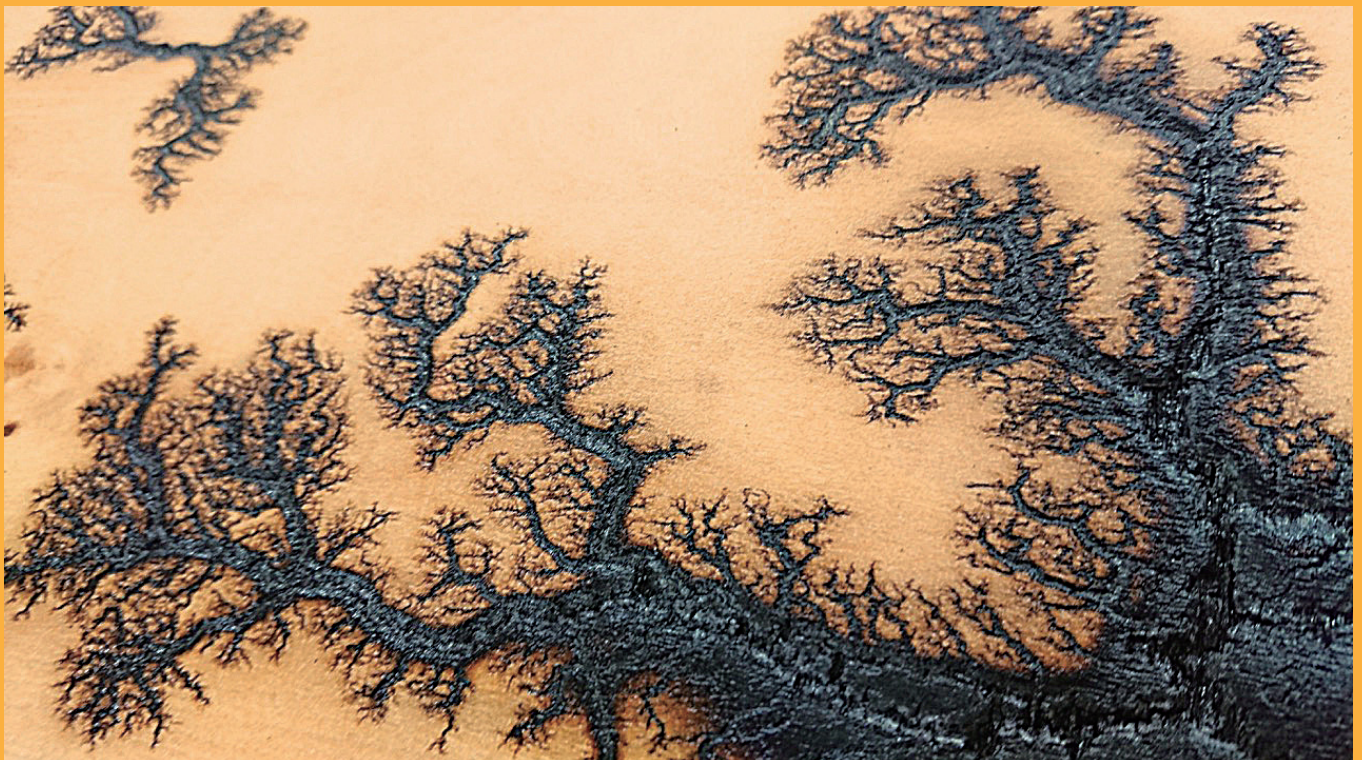
題名：「木の表面に描かれるリヒテンベルク図形」(文化祭で木材に絶縁破壊痕を刻む実験を行った際に撮影) / 撮影：荒井誉龍(阿南工業高等専門学校創造技術工学科電気コース) ※黒いこげ痕部分
