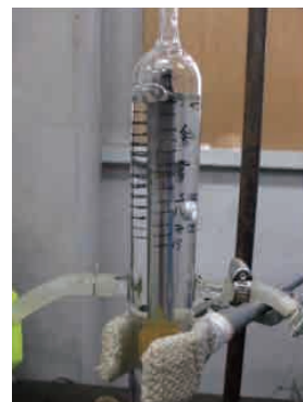
図2 ジルカロイ核燃料被覆管の水蒸気酸化による水素発生 の模擬実験（筆者） \text{Zr} + 2\text{H}_2\text{O} = \text{ZrO}_2 + 2\text{H}_2
