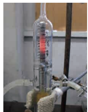
図2 ジルカロイ核燃料被覆管の水蒸気酸化による水素発生 の模擬実験（筆者） \text{Zr} + 2\text{H}_2\text{O} = \text{ZrO}_2 + 2\text{H}_2
