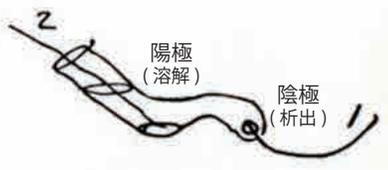
図2 金属の溶解・析出実験用ガラス管形状(鉛,スズで実験)
