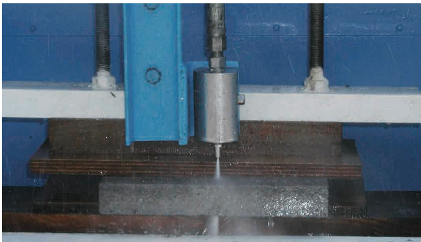
ウォータージェットで岩石を切断する様子（白河溶結凝灰岩 噴射圧力 1000 atm, ノズル径 1.0 mm）
