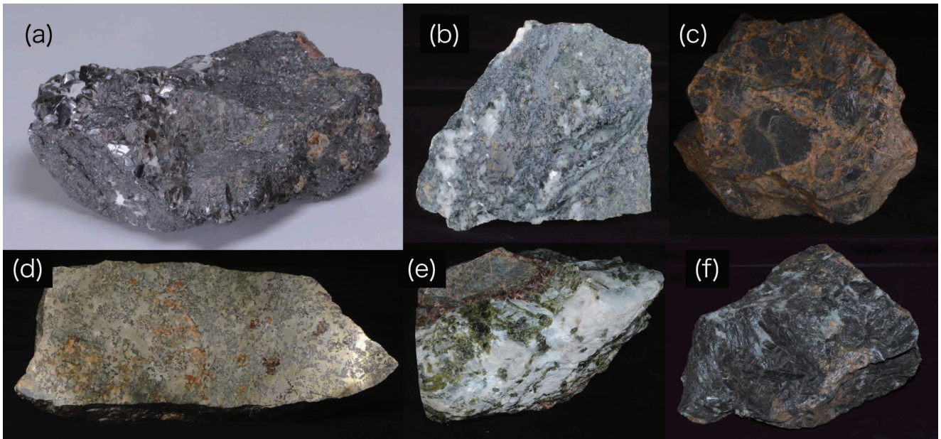
図5 釜石鉱山産の展示標本 (a) 鉄鉱石 (磁鉄鉱). (b) 鉄鉱石 (灰色を帯びた部分が赤鉄鉱). (c) 角礫スカルン. 角礫状になった磁鉄鉱 (黒色) と、その間を埋める柘榴石 (茶色). (d) 銅鉱石 (黄銅鉱・キューバ鉱). (e) スカルン鉱物と石灰岩. 写真上から柘榴石 (茶色) 緑簾石 (緑色), 方解石 (白色). (f) スカルン鉱物 (灰鉄輝石)
