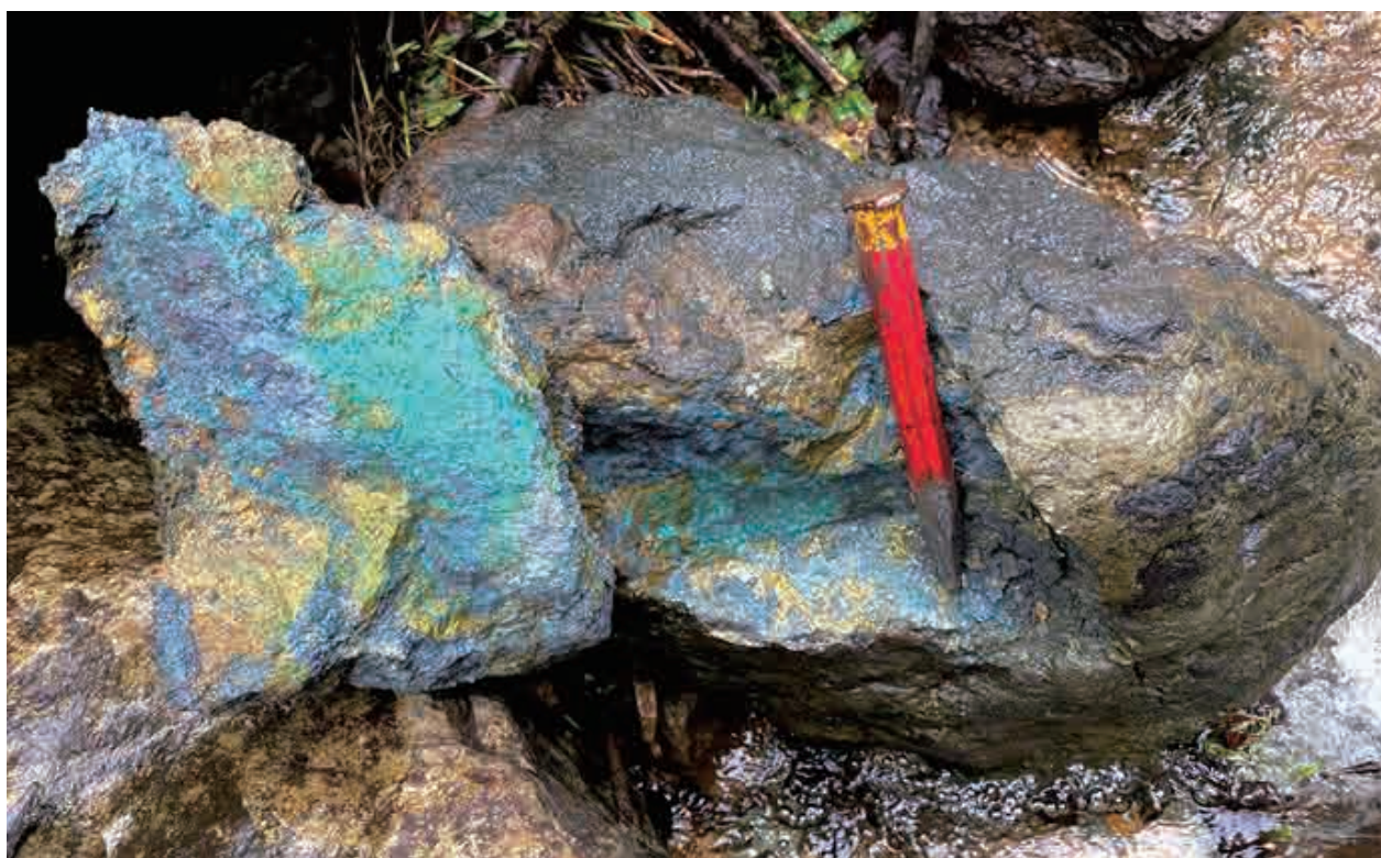
新潟県赤谷鉱床でみられた鉄銅鉱石（黒色部が赤鉄鉱，黄金色部が黄銅鉱，緑青色部が孔雀石）
