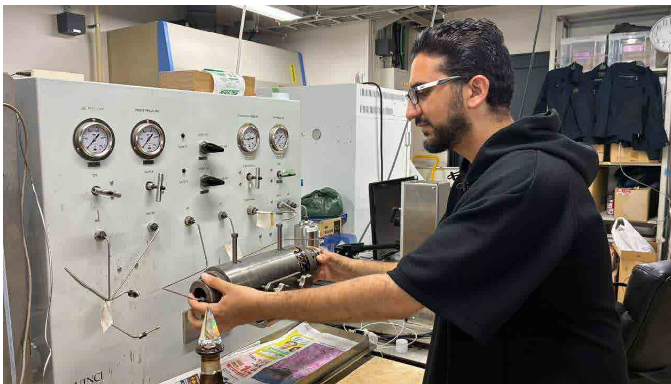
模擬貯留岩を用いたコアフラッド試験の様子
